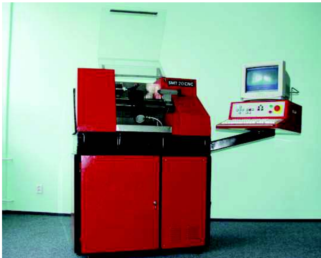
Obr. 231 Soustruh SMT 20 CNC s řídicím systémem
