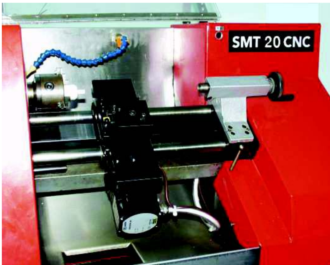
Obr. 232 Pracovní prostor soustruhu SMT 20 CNC
