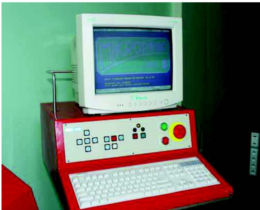
Obr. 234 CNC řídicí systém stroje s ovládacími prvky
